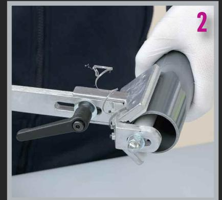
Rohre mit einem Rohranschräggerät anfasen.
